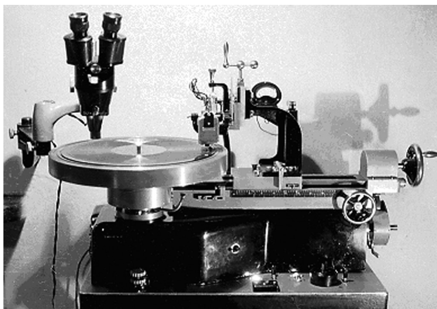
Na takiej maszynie nagrywało się płyty gramofonowe w Zakładzie Nagrań Dźwiękowych w roku 1954. Fot. G.Malanowski
